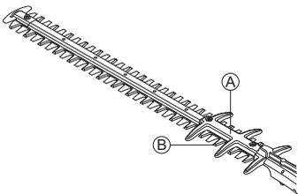
Pārbaudiet nažu aizsargu, lai tas nav bojāts un deformēts. Saliektu vai bojātu asmeņu aizsargi ir jānomaina.
