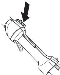
**UZMANĪBU!** Stop kontakts automātiski atgriežas iedarbināšanas pozīcijā. Lai izvairītos no nejaušas iedarbināšanas, aizdedzes sveces uzgalis vienmēr ir jāatvieno no aizdedzes sveces jebkurā montāžas, kontroles un/vai apkopes gadījumā.
